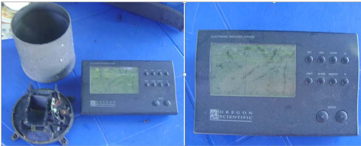
Figura 13- 4.2.2.5 Pluviómetro automático - SAT río Perla
