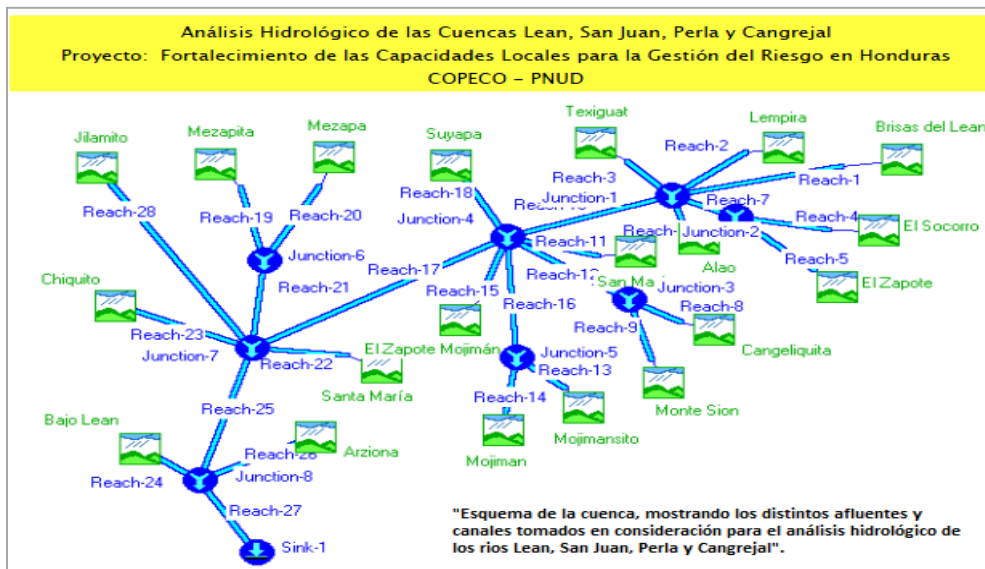
Figura 6 - 4.2.1.1 - Esquema del Modelo HEC-HMS - ríos Lean, San Juan, Perla y Cangrejal Esquema del modelo HEC HMS - Análisis hidrológico de las cuencas de los ríos Leán, San Juan, Perla y Cangrejal. Fuente: Proyecto: Fortalecimiento de las Capacidades Locales para la Gestión del Riesgo en Honduras COPECO – PNUD – Año 2000.
