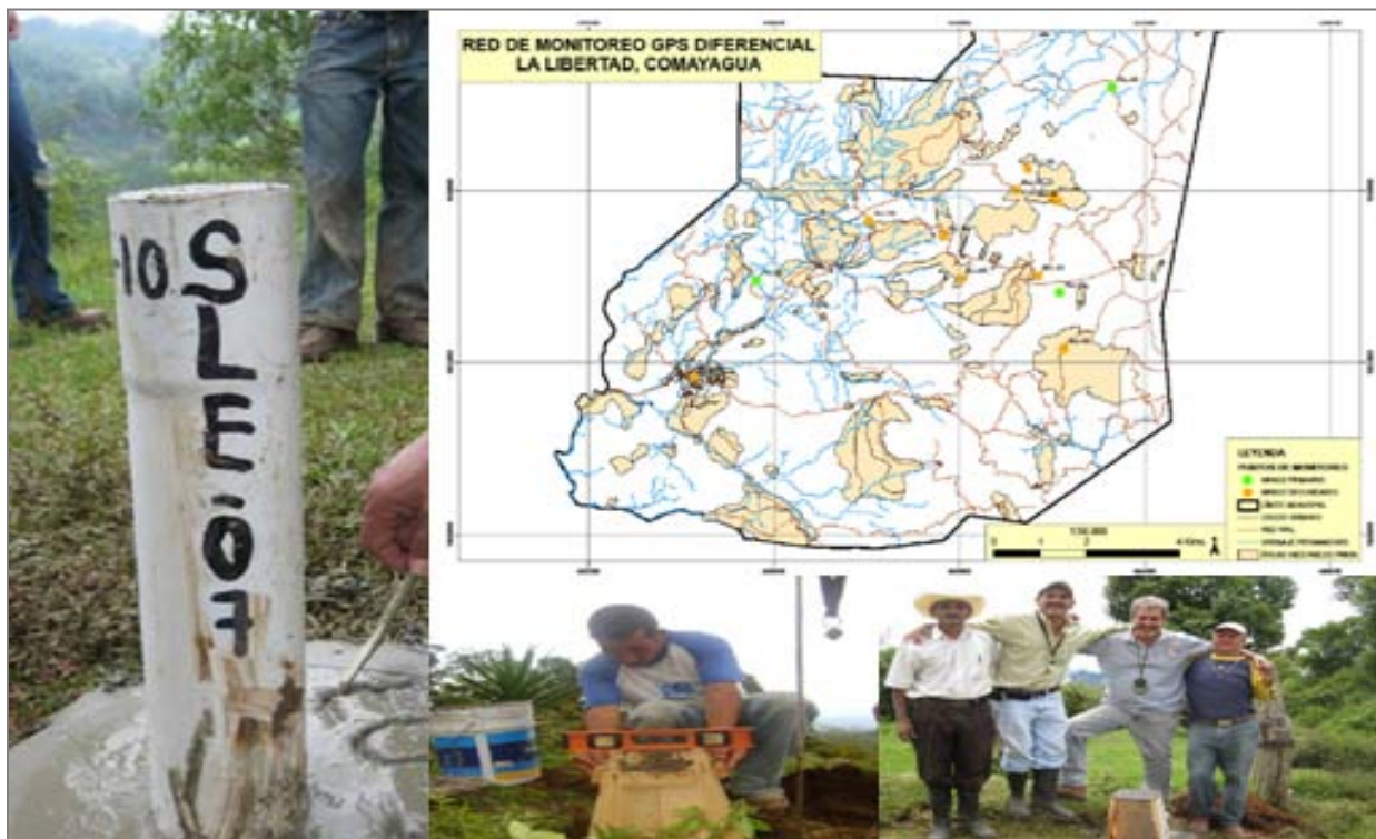
Figura 18 - 4.2.2.9 Mingos para la Red de Monitoreo a Deslizamientos con GPS con corrección diferencial - PMDN - COPECO
